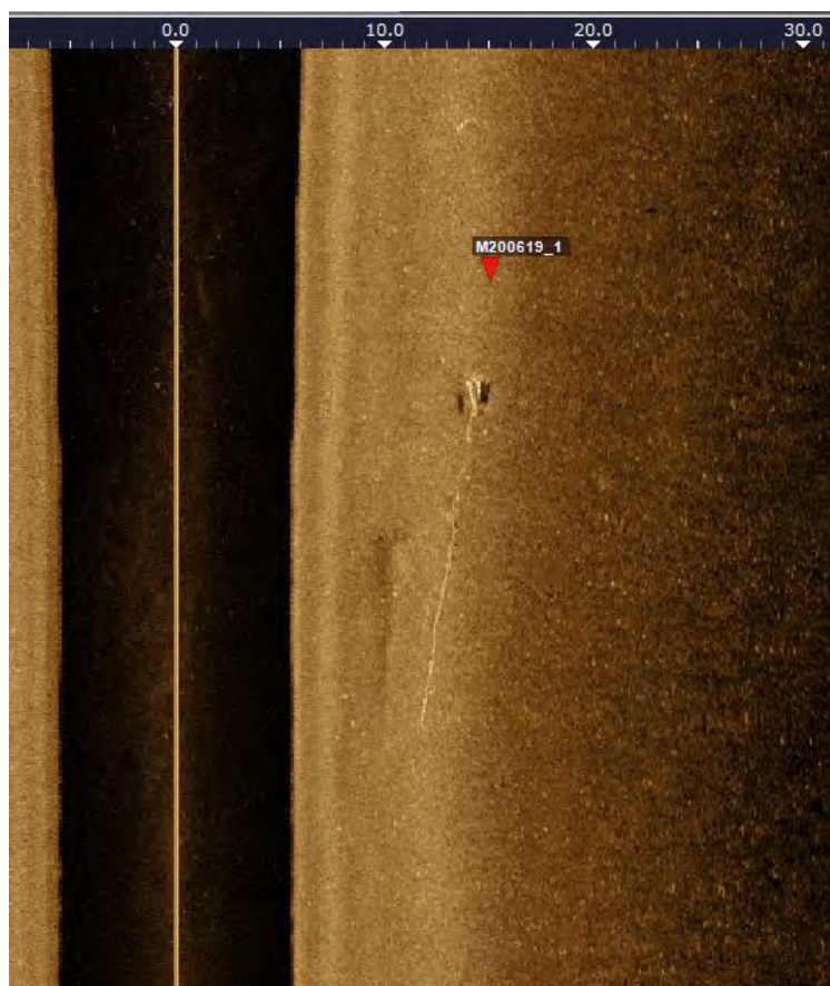
Figur 5 – Moringsstein med tau, ikke lenger i bruk.
